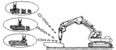
Остановите работу гидромолота, сразу же, как только объект работы разрушился. Следствием продолжения работы может быть чрезмерное изнашивание главных компонентов или повреждение частей молота.
